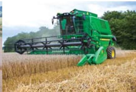
à frente da ceifeira-debulhadora, para que o operador possa ver comodamente tanto a plataforma como a altura do restolho sem necessidade de se inclinar para a frente, além de conseguir uma alimentação mais uniforme e um manejo do material muito suave.
